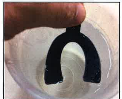
端の部分が浮く
